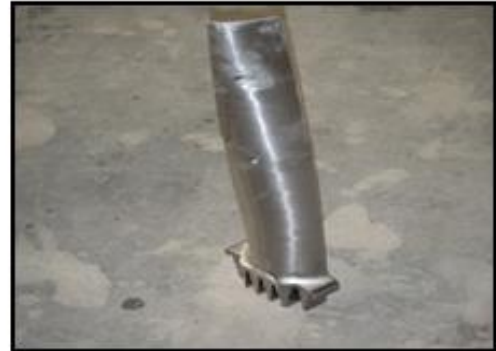
الشكل (3): يوضح ريشة المرحلة الأخيرة من التوربين البخاري في محطة بيجي الحرارية.
